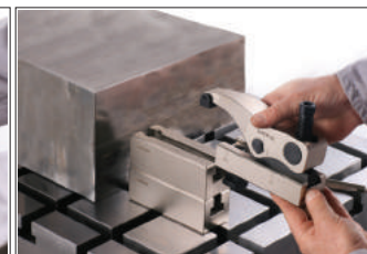
• K.K.S.P inbus civata ile "T" pabuca karşılık "T" kanala takilenen pozisyona getir
